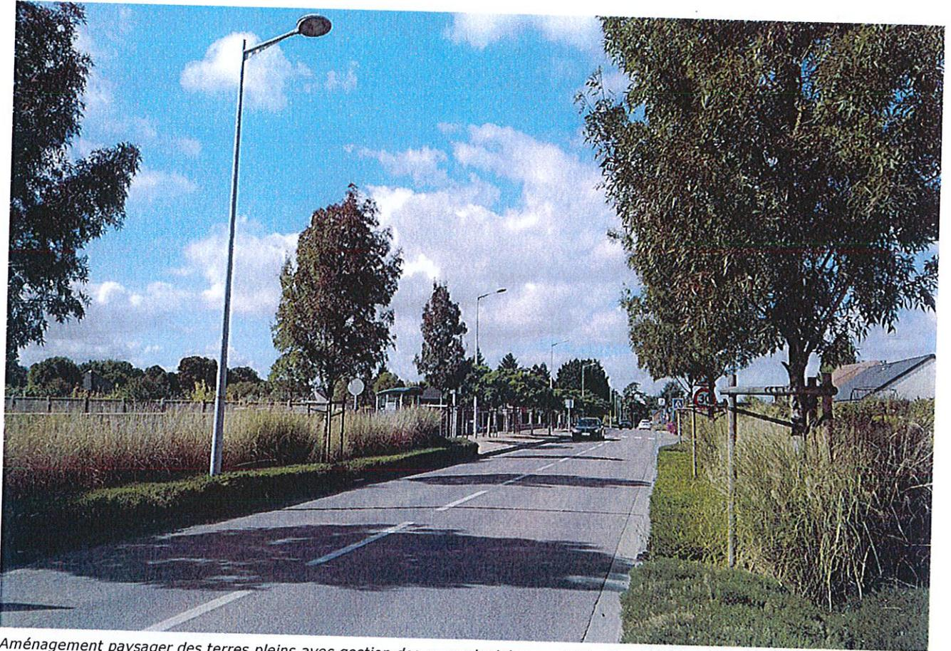
*Aménagement paysager des terres pleins avec gestion des eaux pluviales par infiltration dans des fossés et des noues engazonnées et plantées. Emprise voirie de 5,5m à 6m de large (double sens).*
